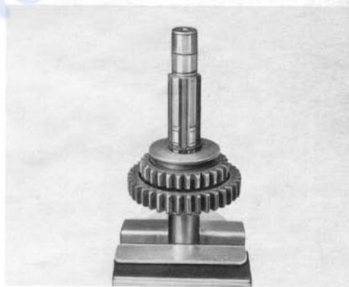
Nun schiebt man das nächst größere Zahnrad ohne Keilnuten (30 Zähne, 4. Gang) so auf, daß die Klauen nach oben zeigen, worauf wieder eine Anlaufscheibe und ein Sicherungsring folgt (s. Bild 22).
